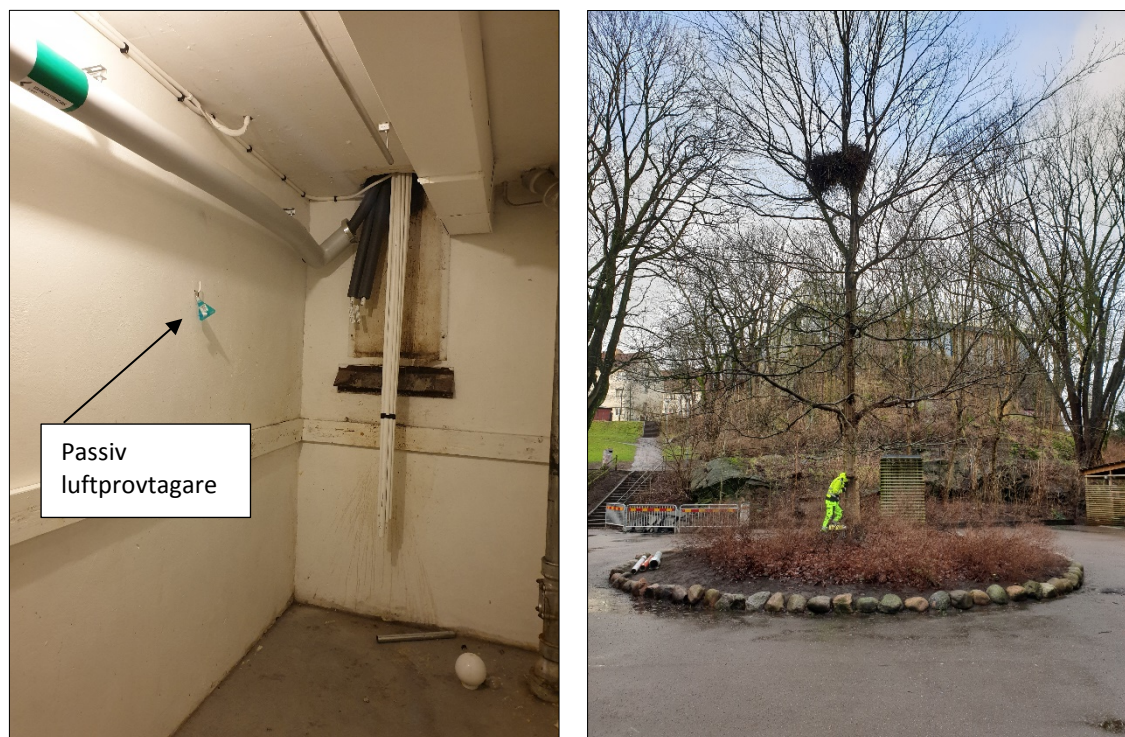
Figur 4. Till vänster passiv luftprovtagning med radiello. Till höger provtagning av träd kärna (T2).
