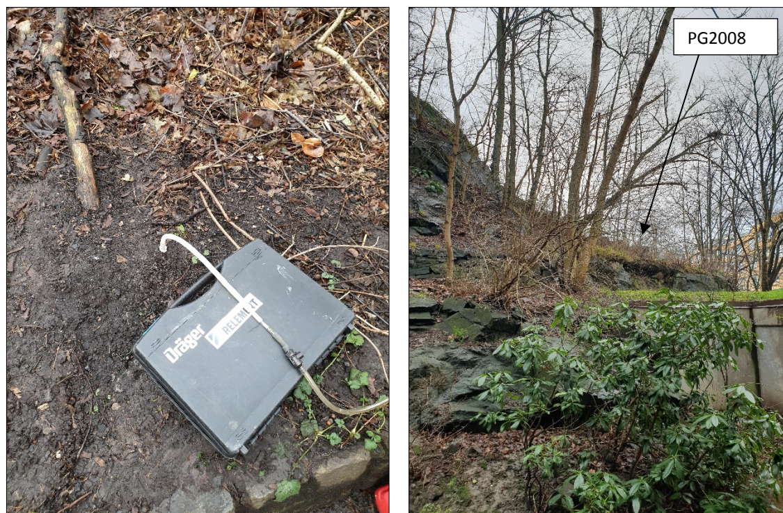
Figur 5. Till vänster pumpning av luft genom kolrör. Till höger lokalisering av PG2008.
